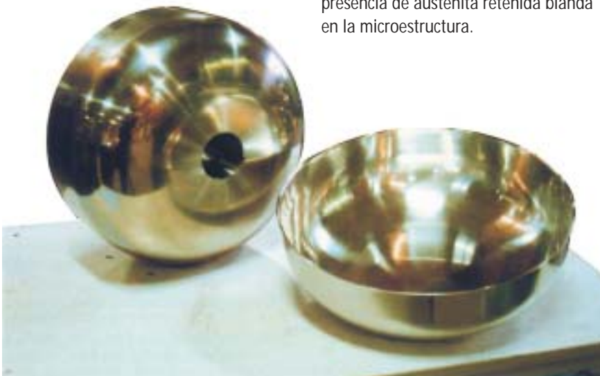
Utillaje para embutición profunda de ensaladeras de acero inoxidable. El material utilizado en el utillaje es SVERKER 21.
