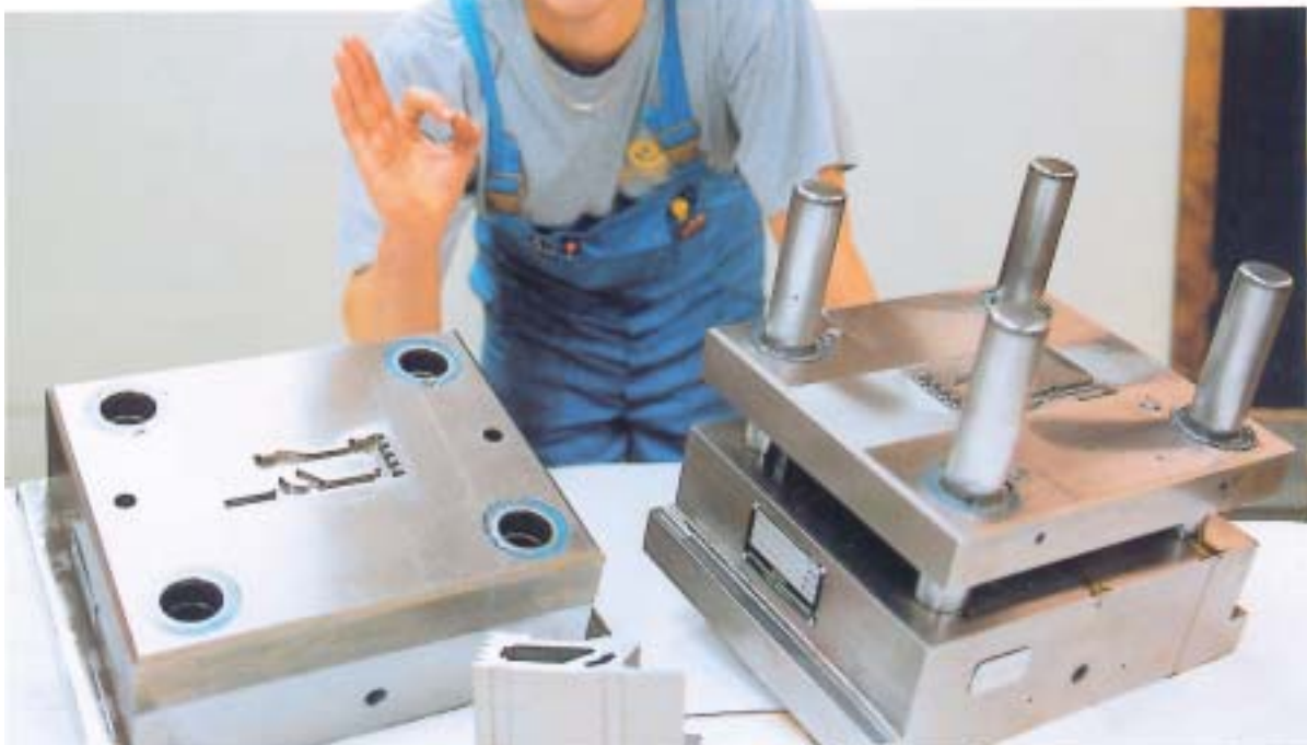
Utillaje para corte fino realizado con VANADIS 4.
