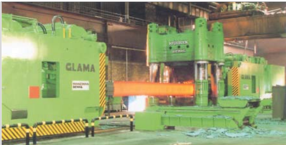
Forjado de barras en la forja de la fabrica.
