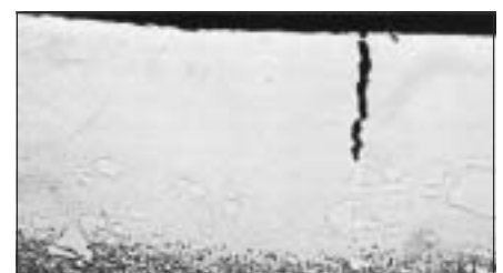
Fig. 10. Superficie de SVERKER 21 después de haber realizado un electroerosionado de desbaste. La capa blanca es frágil y contiene grietas.
