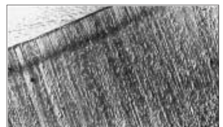
Fig. 5. Fotografía SEM de un punzón realizado con material D2 fuera de servicio a causa del desgaste abrasivo (material de trabajo acero 1% C a 46 HRC).
