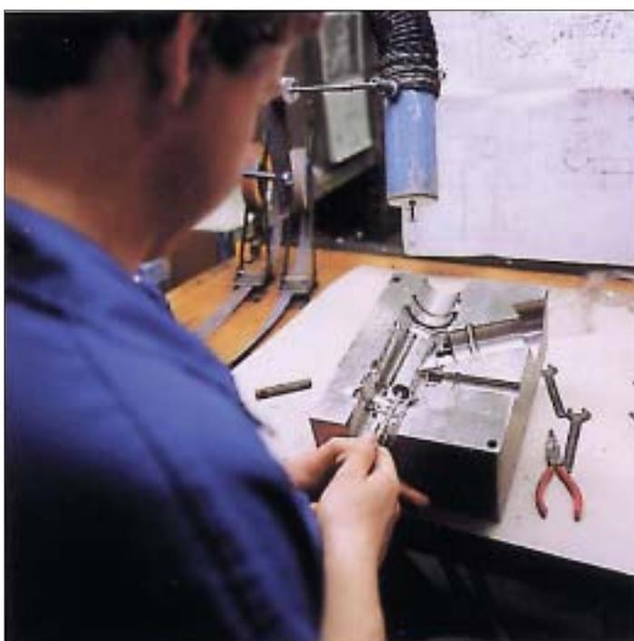
*Fabricación de un molde para fundición inyectada de latón.*
